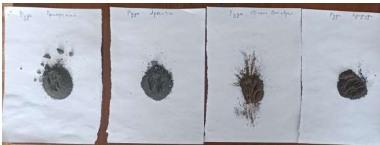
Рисунок 3. Руда измельченная шаровой мельницей
