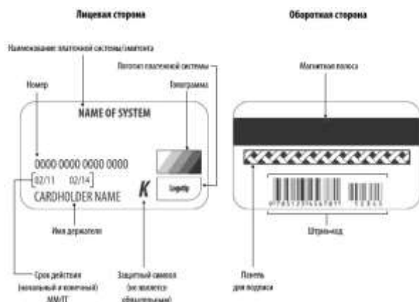
Рисунок 1. Схема пластиковой банковской карты.
